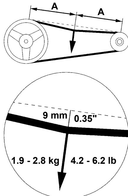
Vérifiez la tension de toutes les courroies. S'il n'est pas possible de régler un jeu de courroies afin que toutes les courroies aient la tension appropriée, le jeu complet doit être remplacé.
