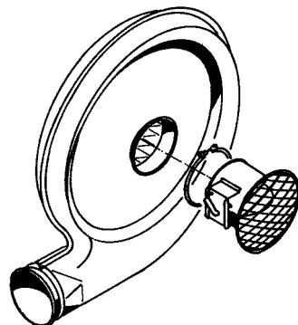
**TRL 75 - Indsugningsgitter, blænde og boltkobling**
