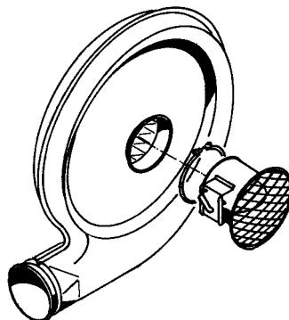
**TRL 75 - Grille de protection, cône d'admission et colliers de serrage à boulons**
