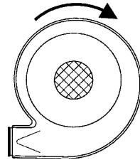
Bitte beachten Sie, dass die Gebläse TRL 20/40 (50Hz) normalerweise nicht ohne Injektor betrieben werden dürfen, da andernfalls der Motor überlastet werden kann. Auf einen Injektor kann jedoch verzichtet werden, wenn die Luftleistung des Gebläses so begrenzt wird, dass der Nennstrom des Motors nicht überschritten wird (siehe Typenschild des Motors).
