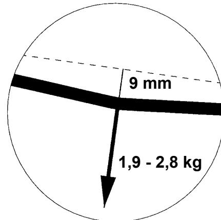
Kontrollieren Sie stets alle Riemen. Ist es nicht möglich, einen Satz Riemen so zu spannen, dass alle Riemen die erforderliche Spannung haben, ist der ganze Riemensatz auszutauschen.
