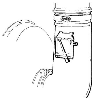
Son particularmente adecuados para realizar transportes neumáticos. El regulador de aire mantiene un caudal de aire constante, incluso cuando el punto de trabajo de la instalación varía durante su funcionamiento. Este asegura que la velocidad del aire en la tubería standard OK160 de Kongskilde se mantiene constante en aprox. 25 m/sec, valor adecuado para muchos trabajos de transporte neumático.
