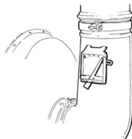
Remarque : Il est uniquement nécessaire de verrouiller le régulateur d'admission d'air si la réduction de la consommation en ampères est demandée par l'alimentation locale.
