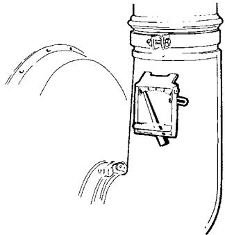
Reguleringsspjældet holder luftmængden konstant, selv om modtrykket i rørledningen varierer. Det sikrer, at lufthastigheden i et Kongskilde OK160 rørsystem hele tiden er ca. 25 meter/sek., hvilket passer til mange pneumatiske transportopgaver.
