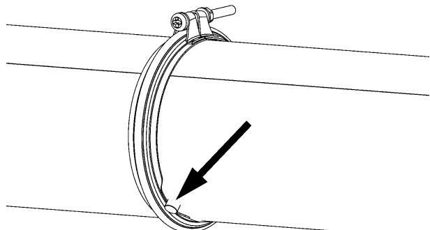
Røret, som monteres på blæserens afgang, skal have en længde på mindst 850 mm, og en diameter på max. 200 mm, så det ikke er muligt at komme i berøring med blæserens/celleslusens rotor, når røret er monteret.
