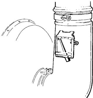
Le régulateur d'air maintient un volume d'air constant - même quand la contre-pression dans la tuyauterie varie pendant le fonctionnement. Il assure que la vitesse de l'air convienne au transport et réduit la surcharge du moteur.
