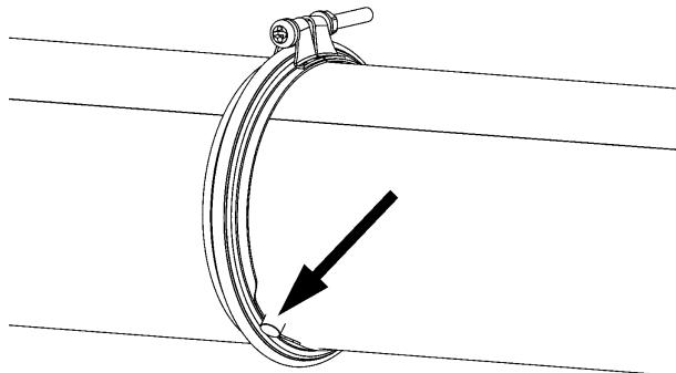
Rura przymocowana do wylotu dmuchawy musi mieć długość minimalną 850 mm przy średnicy maksymalnej 200 mm w celu zapobiegania ewentualnemu zetknięciu z wirnikiem dmuchawy/zaworu obrotowego podczas montowania rury.
