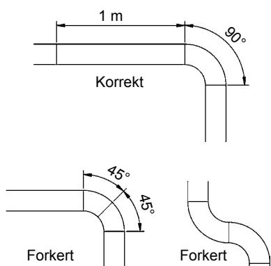
Det anbefales at indsætte et kraftigere 1 meter rør (OKR/OKD) efter en bøjning, da dette stykke er utsat for et større slid fra materialet.
