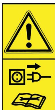
Należy zawsze zatrzymać dmuchawę przed przystąpieniem do naprawy i konserwacji oraz dopilnować, aby dmuchawa nie mogła zostać włączonaomyłkowo.
