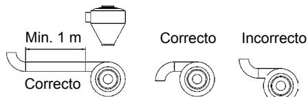
No instale un codo justo antes del ciclón al revés del sentido de giro del propio ciclón. Si se hiciera, se reduciría mucho la capacidad del ciclón.
