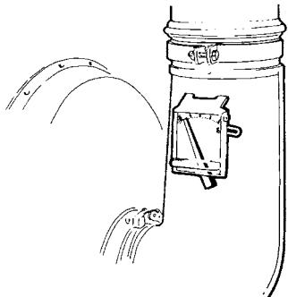
Der Einlassregler hält die Luftmenge konstant, auch wenn der Gegendruck während des Betriebes variiert. So wird gewährleistet, dass die Luftgeschwindigkeit in einem Kongskilde OK160-Rohrsystem konstant ca. 25m/Sek. beträgt, was für eine Vielzahl pneumatischer Förderaufgaben geeignet ist.
