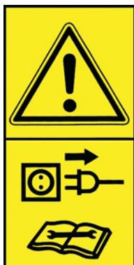
Unterbrechen Sie vor Reparatur- und Wartungsarbeiten immer die Stromzufuhr, und stellen Sie sicher, dass das Gebläse nicht versehentlich gestartet werden kann.
