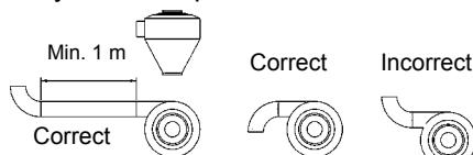
S'il est nécessaire d'installer un coude avant le cyclone, celui-ci doit s'orienter dans le même sens que le cyclone ou un tuyau droit d'au moins 1 m (3,3 pieds) doit être installé entre eux.
