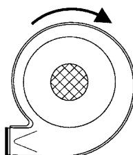
Veuillez noter que les ventilateurs TRL 20/40 (50Hz) et TRL 30/50 (60Hz) ne doivent normalement pas fonctionner sans venturi. Sinon, le moteur peut être sur-
