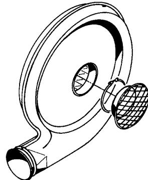
**TRL 55 (TRL 100 bei 60Hz) – Eintrittsgitter, Drosselklappe und Schraubkupplung.**
