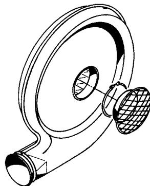
**TRL 55 (TRL100 a 60Hz) - Rejilla de entrada, regulación y abrazaderas de tornillo**
