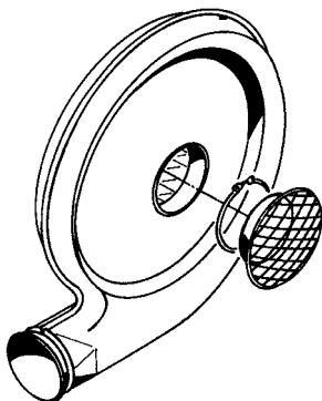
**TRL 55 (TRL100 à 60 Hz) - Grille de protection, commande de réglage et collier de serrage à boulon**
