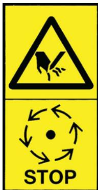
Rotierende Teile dürfen nur bei vollständigem Stillstand berührt werden.
