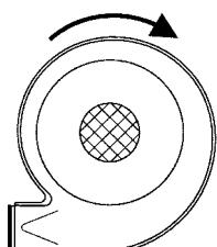
Observe que los ventiladores TRL 20/40 normalmente no deben utilizarse sin un venturi. De lo contrario, el motor puede sobrecargarse. Sin embargo, el venturi puede omitirse si el volumen de aire está limitado eléctricamente. (ver placa motor).
