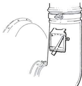
**Bemærk: Det er kun nødvendigt at låse reguleringssspjældet i startposition, hvis det på grund af el-forsyningen er behov for at reducere motorens amperes forbrug under opstarten.**
