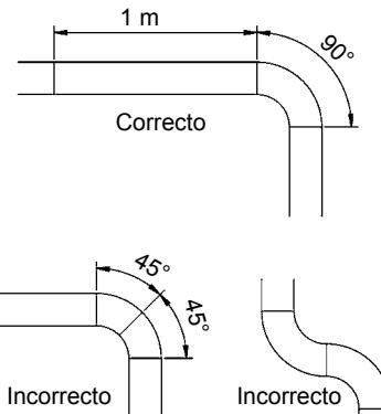
Se recomienda usar un conducto reforzado de 1 m (3.3 ft) (tipo OKR/OKD) a continuación de cada codo para compensar el desgaste.
