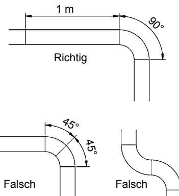
Nach jedem Bogen empfiehlt sich die Montage eines 1-Meter Rohres (OKR/OKD) mit größerer Wandstärke, da dieser Teil der Rohrleitung einer starken Abnutzung durch das Material ausgesetzt ist.
