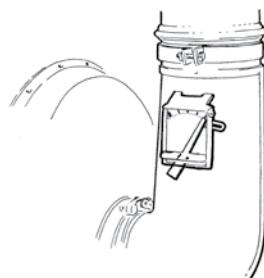
**Uwaga: Zablokowanie regulatora poboru powietrza jest konieczne tylko wtedy, gdy lokalne zasilanie wymaga zredukowania zużycia prądu.**
