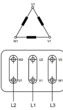
Conexión en triángulo
