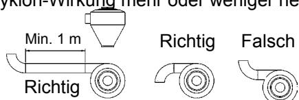
Ist ein Bogen vor dem Zyklon unerlässlich, muss dessen Krümmung in dieselbe Richtung wie der Zyklon "zeigen", oder man setzt ein gerades, mindestens 1m langes Rohr dazwischen.
