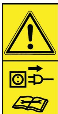
Pare siempre el ventilador antes de proceder a su reparación y mantenimiento y evite cualquier arranque del mismo de manera accidental.
