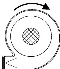
Należy pamiętać, że dmuchawy TRL 20/40 (50Hz) i TRL 30/50 (60 Hz) zwykle nie mogą być obsługiwane bez użycia zwężki Venturiego. W przeciwnym razie silnik może być przeciążony. Zwężkę Venturiego
