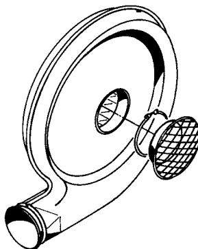
**TRL 55 (TRL100 przy 60 Hz) - siatka wlotowa, przepustnica regulacyjna i klamra skręcana na śrubę**
